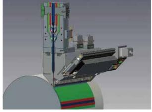
对于特殊的薄膜应用领域,**JWELL** 为薄膜生产线配置了在线的 **MDO** 单元。 单轴拉伸工艺使得薄膜成型在如下方面变的可控,如拉伸强度、收缩率、刚度、阻隔性和光学特性等。此外,通过拉伸来达到薄膜的轻量化,仍将引领着流延膜行业增长的趋势。
